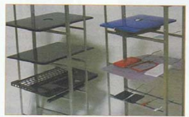
ペイント時はガジェットを構成するパーツを分解しての作業となる。写真は業者にて塗装を乾かす作業中
